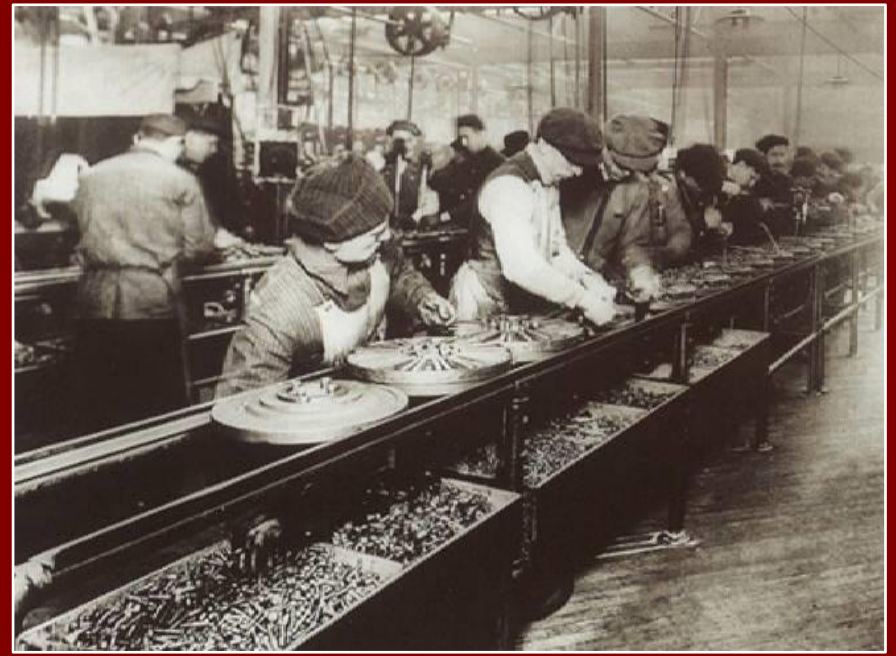
LINHA DE MONTAGEM DE CARROS (segundo F. W. Taylor) FÁBRICAS FORD, EUA, 1915
