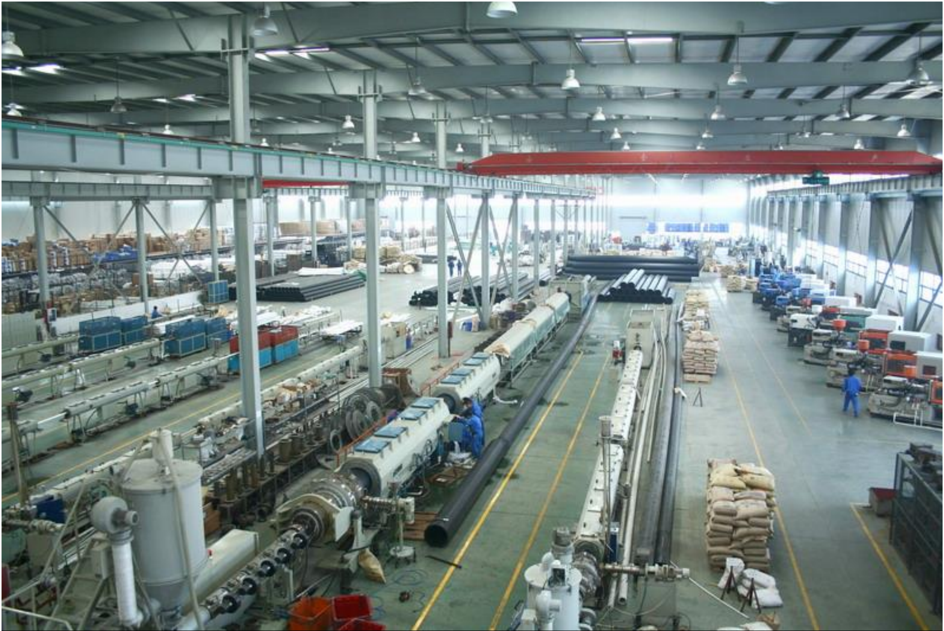
Produção de tubos em matéria plástica (PVC) por extrusão
